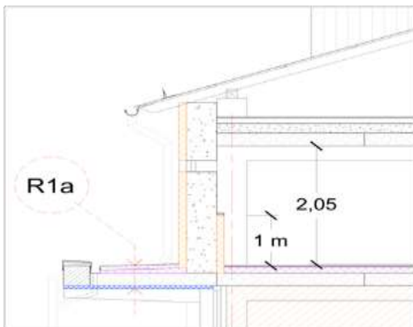
Figura 2-1: Procedeele de izolare și stratificările elementelor constructive
