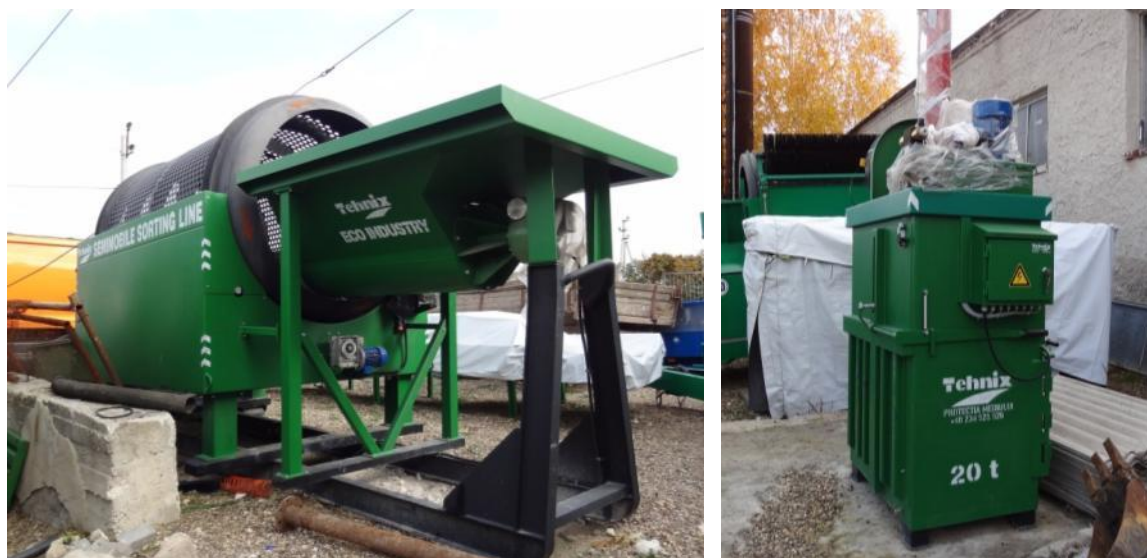
Figura 5-1: Utilaj de sortare și balotare (stânga: sita rotativă, dreapta: presa de balotat)
