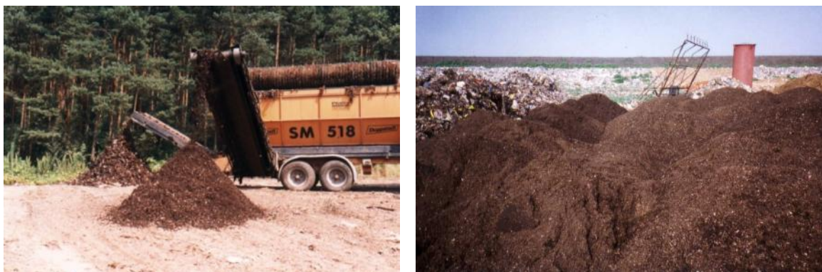
Figura 5-10: BS cernută (stânga), separarea materialului pentru oxidarea metanului (dreapta)
