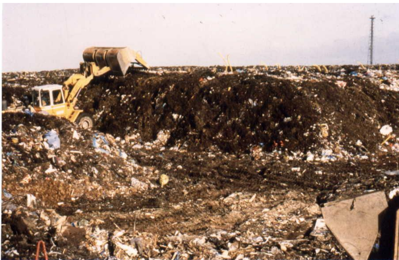
Figura 5-12: Efectul „coșului de fum” - aranjarea grămezilor
